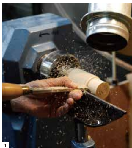
(1) 木を回転させながら刃物で削り出す「旋盤加工」で形を整えていく。(2) 材料となるのは小径木。伊那谷の様々な樹種の木が使われている。(3) 左から株式会社やまとわの中村氏、料理家の蓮池氏
